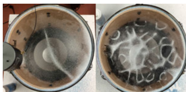
Figure 6. Deux figures de Chladni : le sel forme des figures sur la membrane vibrante.
