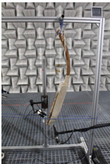
Figure 13. Mesure de la harpe dans la chambre anéchoïque du campus Pierre-et-Marie-Curie de Sorbonne Université.
